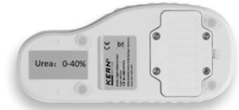
Vista posteriore, coperchio del vano batterie avvitato
